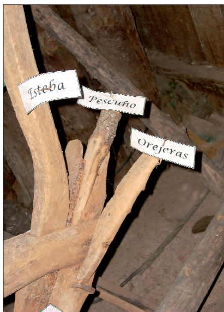
Cama del arado. Todas las piezas se juntan en la cama.
