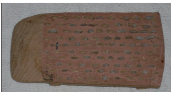
Parte bajera del trillo; obsérvense las piedras cortantes de pedernal.
