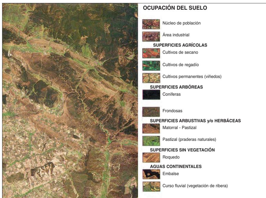
Figura 3.9. Imagen Landsat de la zona de estudio a escala original 1/1.000.000 (I.G.N., 1992) donde se distinguen muy bien en tono marrón los afloramientos calcáreos que conforman el macizo kárstico, así como el trazado sinuoso del Cañón del río Lobos.
