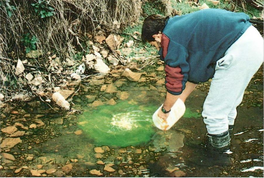
Foto 6. Prueba de comunicación entre el río Navaleno y el Manantial de La Galiana. Obsérvese el remolino que delata la presencia de un sumidero en el lecho del río. El colorante tardó 10 días en recorrer subterráneamente el acuífero y salir en el manantial de La Galiana. (Foto R.S.).
