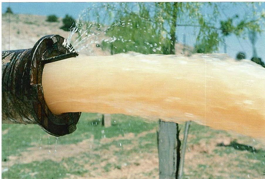
Foto 29. Ensayos de bombeo en Gormaz, en los que se verificó las buenas perspectivas de regulación de los manantiales (Proyecto Hidrogeológico de Soria - (SGOP, 1990). (Foto E.S.).
